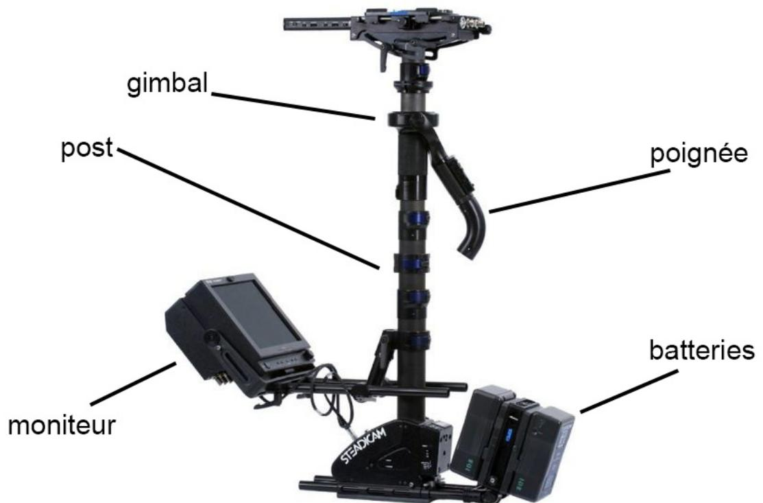
Le *gimbal* est positionné assez haut sur le *sled*. Il s'agit d'un cardan relié à une poignée qui peut pivoter sur trois axes grâce à des roulements. Il s'agit d'un des éléments les plus importants du steadicam d'après Fabrice Carballares, responsable technique de Planning Caméra, car s'il a un défaut, le steadicam perd de sa maniabilité et ne peut pas
