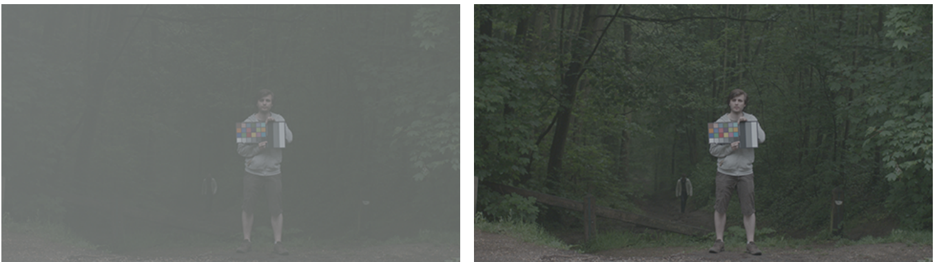
Figure 94. Capture d'image de la forêt (plan 1) avec mires. Varicon allumé (à gauche) et éteint (à droite).
