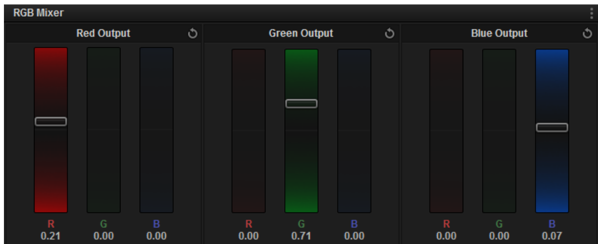
Figure 78. « RGB Mixer » ou mélangeur de couches de DaVinci Resolve 11 Lite. Les valeurs du mélangeur sont déterminées pour la luma vidéo, soit 71% de vert additionné à 21% de rouge et à 7% de bleu.
