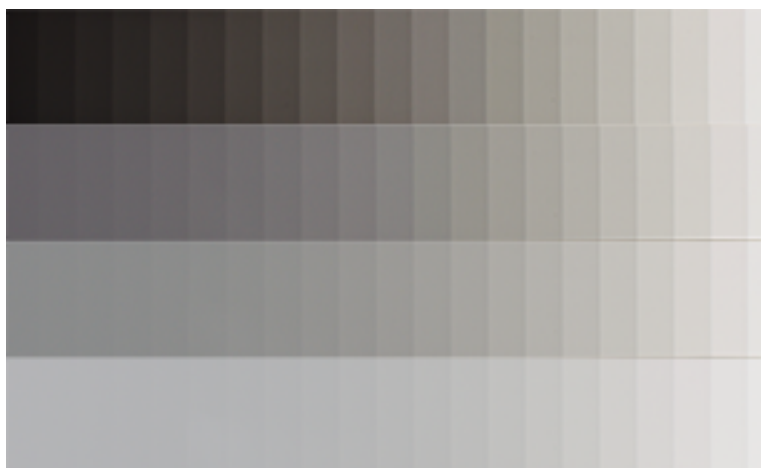
Figure 83. Extraits du modulateur d'incrément 0,10 points de densité. De haut en bas : sans Varicon, Varicon 3, Varicon 5, Varicon 15.
