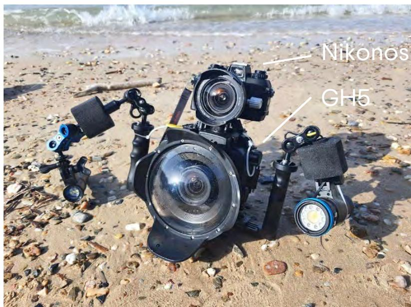
Figure 69 : Photographie de la configuration des appareils photos pour la prise de vue en simultanée
