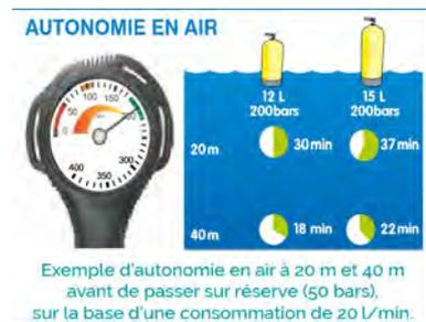
Figure 15 : Manomètre de plongée
