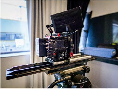
Figure 36 : Corps caméra sur une grande semelle pour pouvoir trouver la pupille d'entrée
