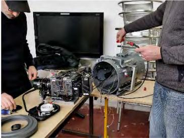
Il faut ensuite choisir un placement optimisé des moteurs de point et de diaphragme grâce à des petites tiges fixées sur le corps caméra. Ils doivent pouvoir être écartés de l'optique pour que l'assistant caméra puisse la retirer. De plus il n'est pas possible d'utiliser une mate box pour ajouter
