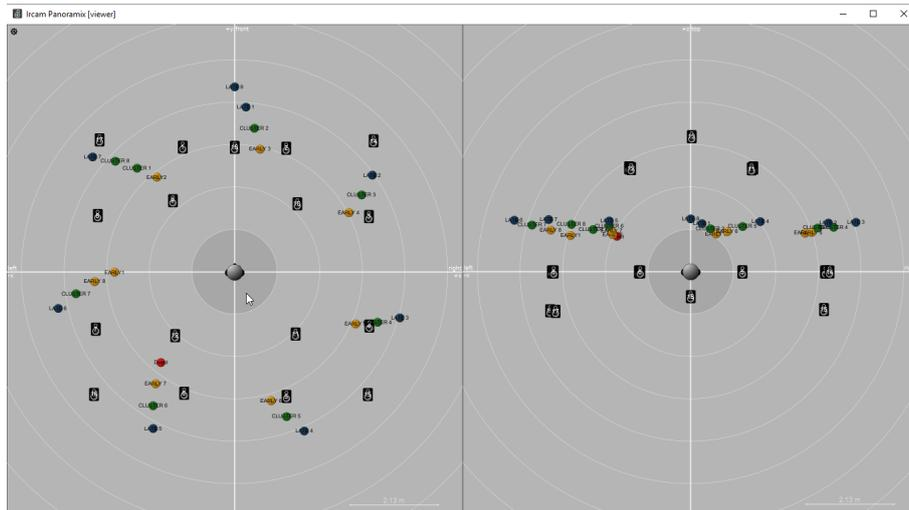
FIGURE 3.27 – Représentation des positions des réflexions de la spirale, destruction de l'impression de trajectoire par plusieurs révolutions. En rouge le son direct, en orange les premières réflexions, en vert les réflexions denses et en bleu les réflexions tardives. À gauche vue du dessus, à droite vue de face (derrière l'auditeur).
