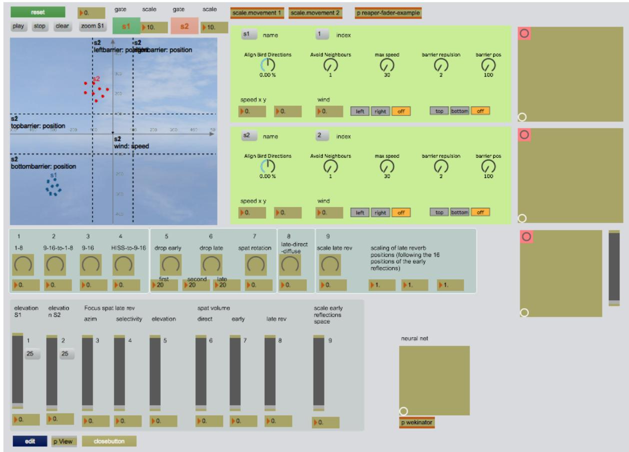
FIGURE 3.52 – Interface de contrôle du simulateur d’acoustique "perceptif", en haut à gauche la position des "oiseaux", à sa droite les contrôles de l’algorithme de *boids*, tout à droite un contrôle du décalage du centre des nuées d’oiseaux, en dessous les potentiomètres rotatifs et faders de contrôle de l’acoustique (temps de réverbération, équilibre des groupes, etc.)
