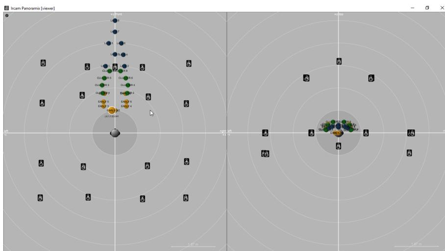
FIGURE 3.24 – Représentation des positions des réflexions du couloir lorsque le guide se trouve à la limite de la seconde pièce. En rouge le son direct, en orange les premières réflexions, en vert les réflexions denses et en bleu les réflexions tardives. À gauche vue du dessus, à droite vue de face (derrière l'auditeur).
