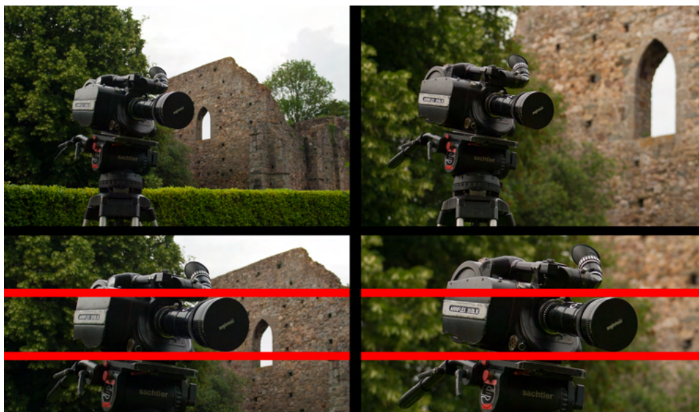
Figure 4 : Photographie réalisée à l'aide d'une focale de 37mm, à une distance de 2,5m (à gauche), et photographie réalisée à l'aide d'une focale de 75mm, à une distance de 5m (à droite). Les cases du bas présentent un détail de l'image du dessus. Illustration de la compression-décompression de l'espace, dû à la relation entre la distance et la focale. Dans les deux cas, les éléments aux premiers plans ont la même taille apparente, contrairement aux éléments d'arrière plans.
