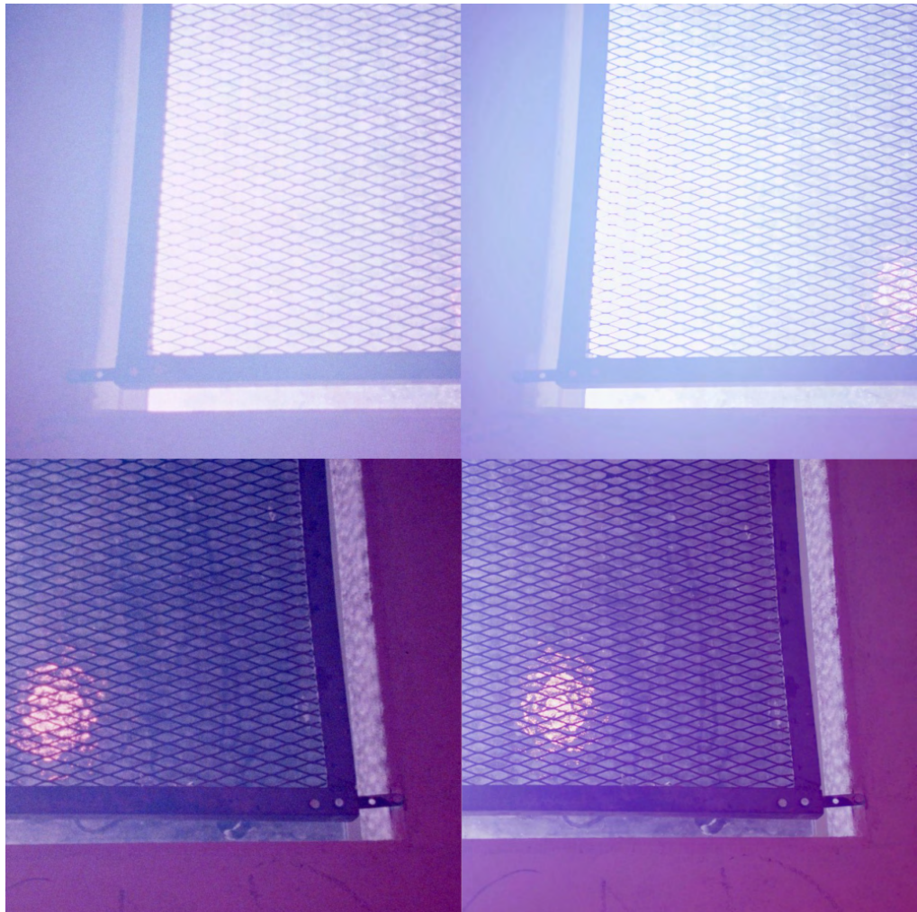
Figure 53 : En haut à gauche, apparition du phénomène de halation sur les zones de fortes luminations en argentique 35mm. Le pouvoir de résolution chute localement. En haut à droite, aux mêmes conditions le phénomène ne se produit pas en numérique. En bas, expositions intermédiaires. Le phénomène ne se produit pas et les deux supports ( Kodak 5219 500T à gauche et Black Magic URSA Mini Pro G2 à droite) ont un rendu relativement similaire, même si le piqué en argentique reste moindre.
