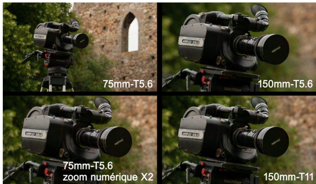
Figure 5 : Photographies réalisées en conservant la même distance au sujet. Le grandissement apparent est modifié soit par une manipulation de postproduction, soit par une modification de la focale au moment de la prise de vue. Nous observons que le choix de la focale ne modifie pas la relation du sujet à l'espace (le rapport de taille entre l'arrière plan et l'avant plan, n'est pas modifié ; seul le rapport de netteté change).
